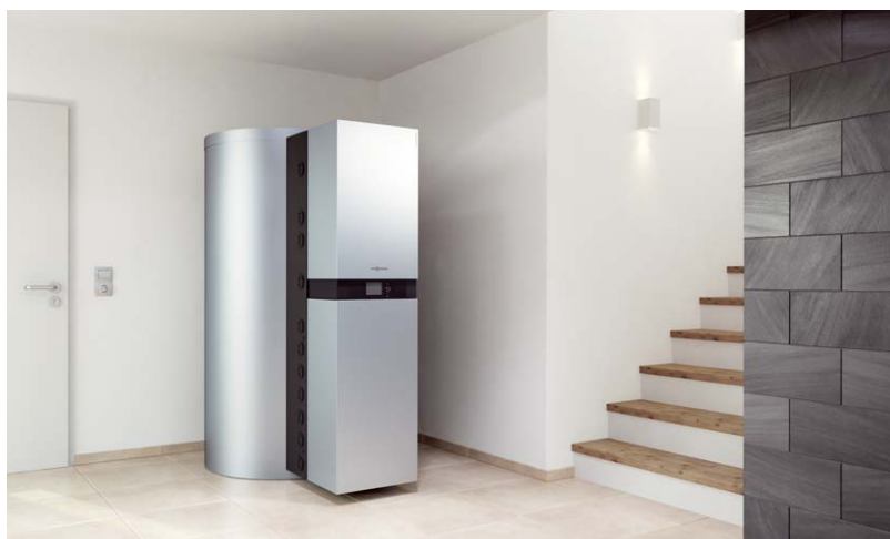
Vitosolar 300-F – kompaktowa centrala grzewcza złożona z gazowego kotła kondensacyjnego, zbiornika buforowego wody grzewczej (poj. 750 litrów), armatury hydraulicznej i automatyki do współpracy z kolektorami słonecznymi dla wspomaganie centralnego ogrzewania domu
